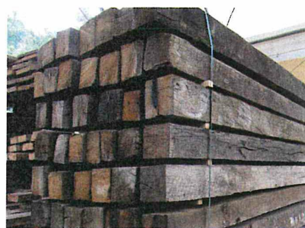
1. kép. Építőipari környezetből kibontott, kategóriába sorolt faanyagok
